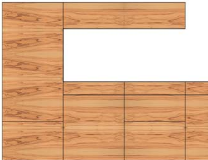
Tischler- und Schreinerarbeit: mit Digitaldruck nachgebildete Furnierabwicklung in Olivenholz
