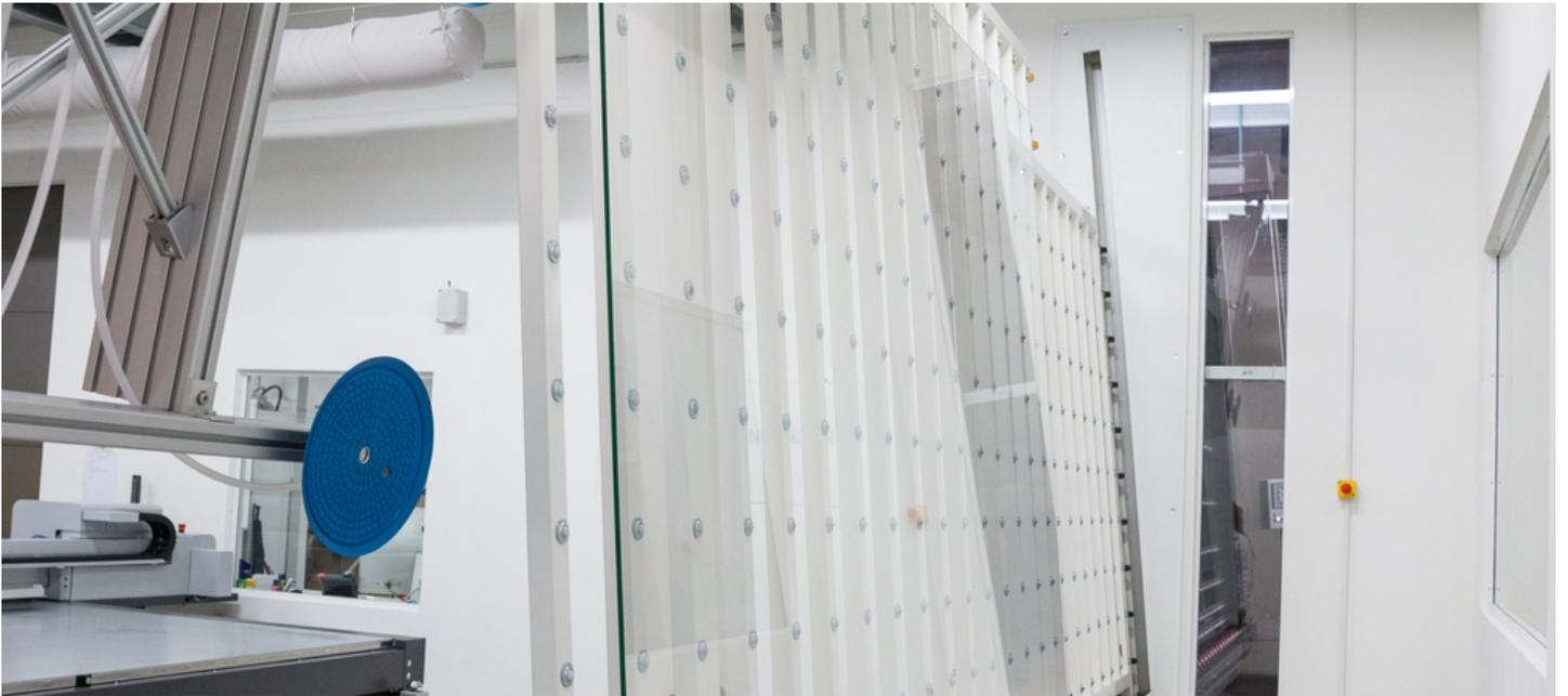
Der eigens entwickelte Kipptisch bringt Glasplatten von der Vertikalen in die Horizontale.
