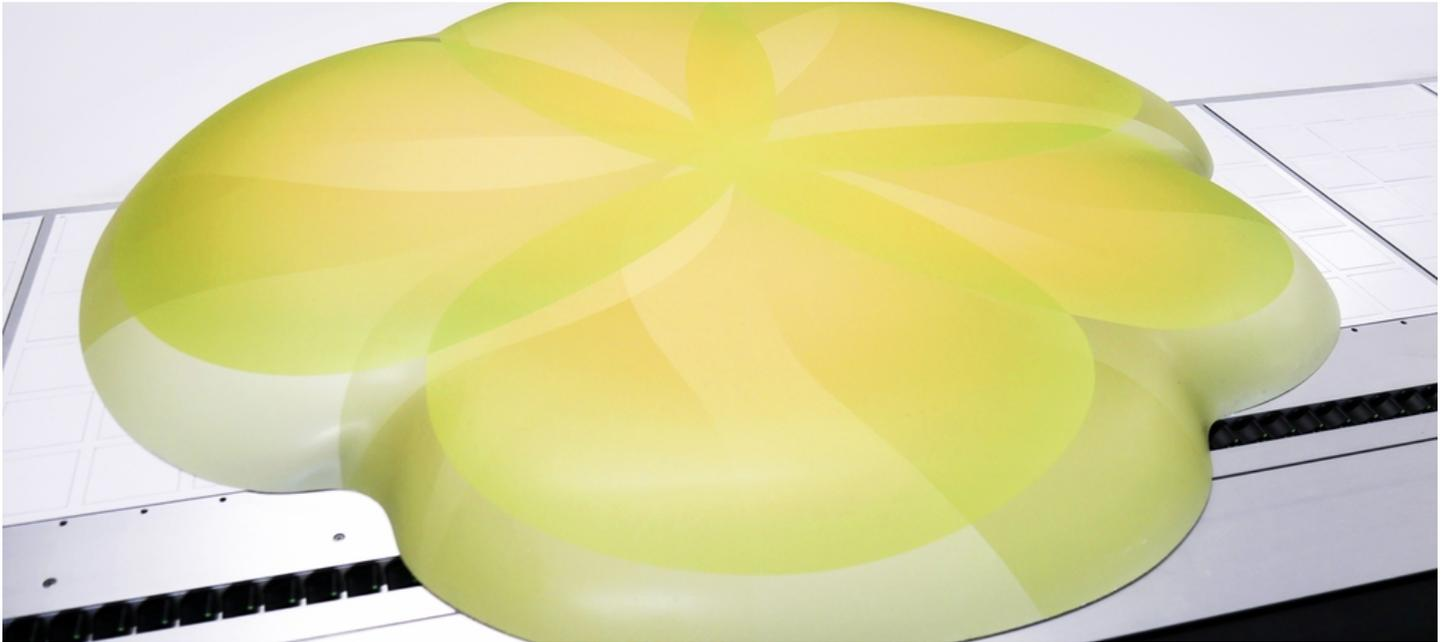
Er berichtet von einem Dekorationsprojekt in einer Drogeriemarktkette, für das Polystyrolplatten nach dem Druck tiefgezogen wurden. «Wir mussten nicht lange üben, die swissQprint-Tinte macht die Verformung mit.» Kolb bestätigt auch, dass die Tinte dauerhaft ist: «Ich habe schon 10-jährige Aussenschilder gesehen, die noch völlig in Ordnung waren.»
